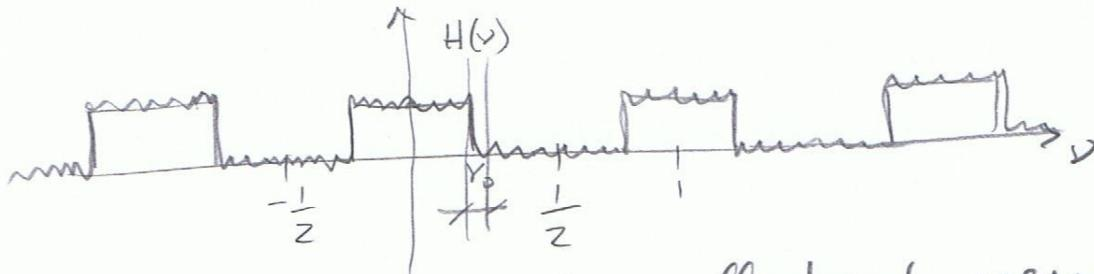
un "ciglio" nelle bande passate e nelle bande oscure e una banda di transizione non ideale. La banda di transizione sarà tanto più stretta quanto più stretto è il lobo principale di  $W(v)$ . L'effetto si infatti l'effetto diffuso tipico del truncamento della serie di Fourier. La larghezza delle bande di transizione è circa  $\frac{2}{N}$ .
