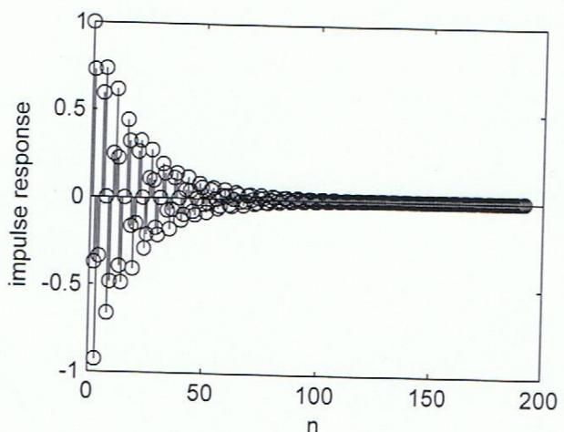
ESEMPIO Filtro a spillo: un filtro che elime una frequenza specifica.
