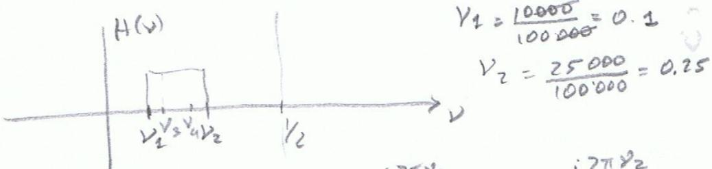
Pioggiamo due zeri a  $Z_1 = e^{j2\pi v_1}$  e  $Z_2 = e^{j2\pi v_2}$  con i loro complessi coniugati, e due poli all'interno del cerchio per fissare sullo z-plane.
