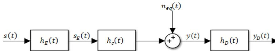
Dove il rumore equivalente a valle del canale ha ovviamente spettro di potenza pari ad
